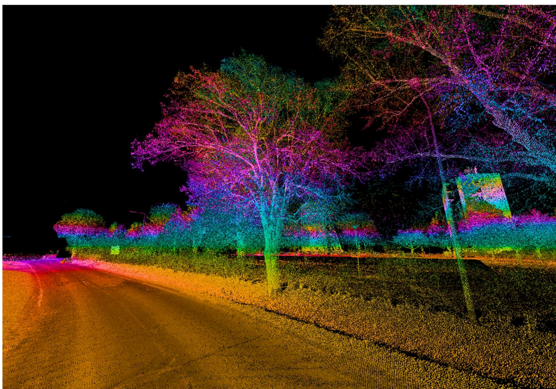
Příklad náhledu na 3D panoramatického snímek a mračno bodů v Toužimi
